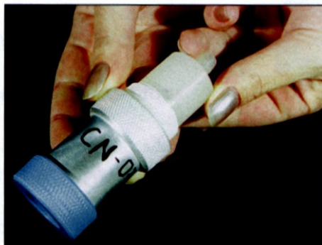
Figura 3. Fechamento do porta-filtro de alumínio
